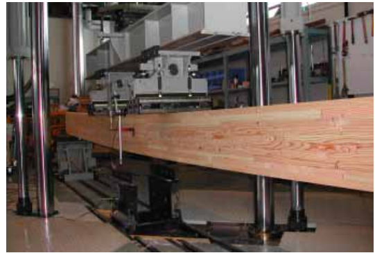
写真1 曲げ強度試験の様子
