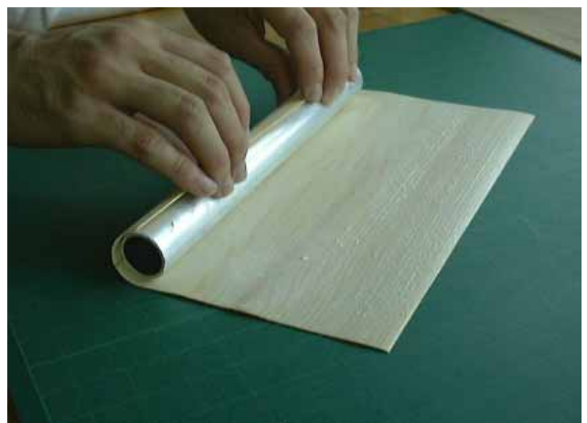
写真2 単板の巻き付け
